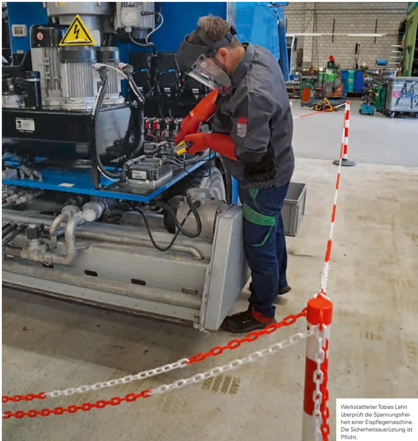
Werkstattleiter Tobias Lehn überprüft die Spannungsfreiheit einer Eispflegemaschine. Die Sicherheitsausrüstung ist Pflicht.
